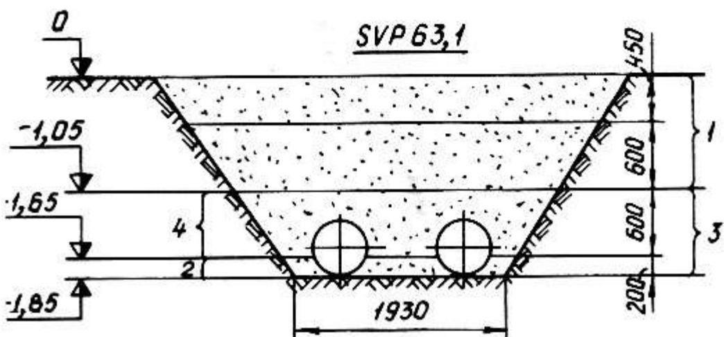
Рис.15. Схемы обратной засыпки и разравнивание грунта при уплотнении вибрационными плитами:
