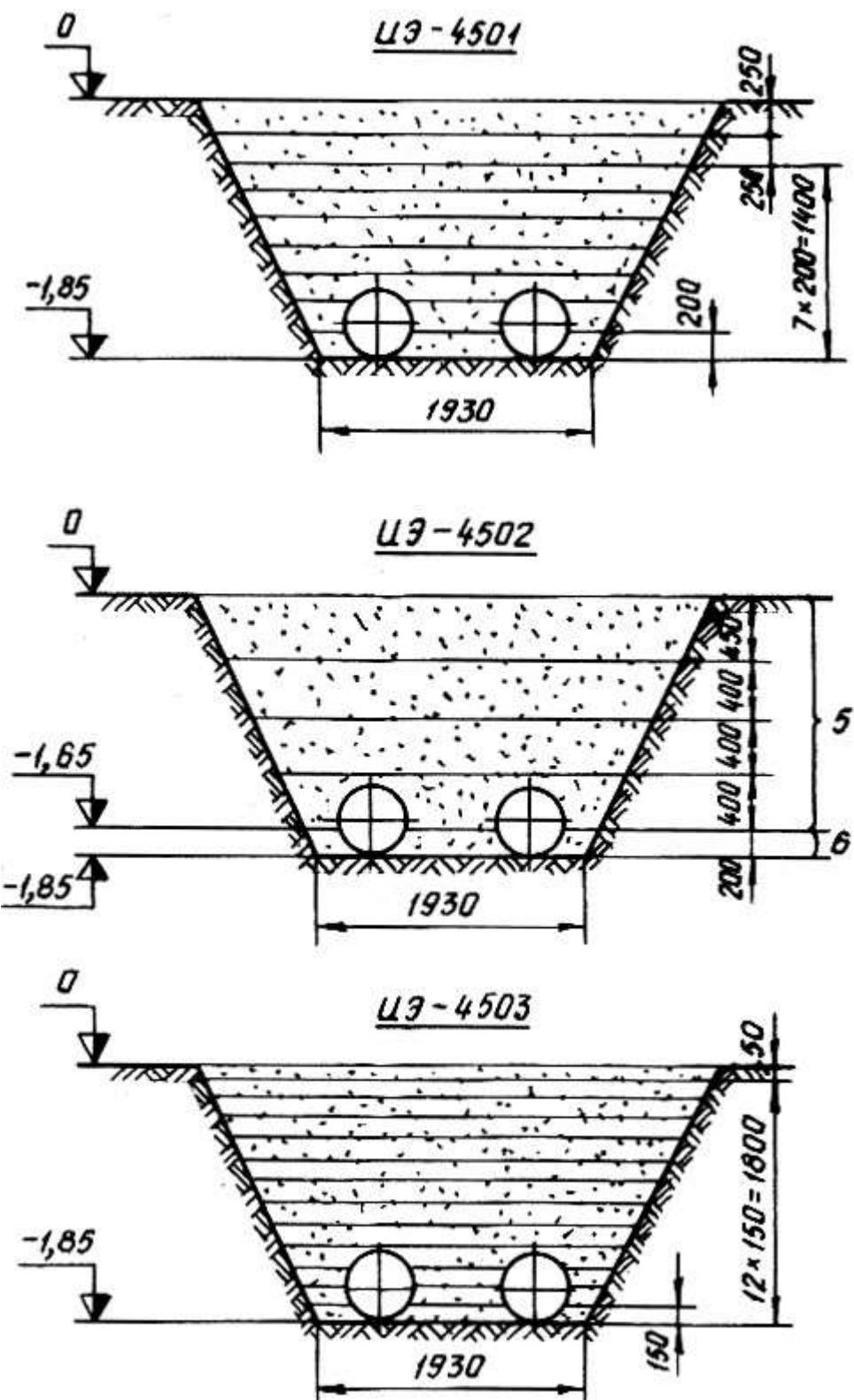
Рис.18. Схемы уплотнения грунта электротрамбовками:
