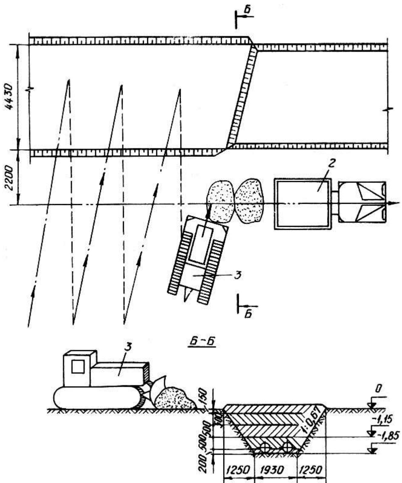
Рис.8. Схема обратной засыпки и разравнивания грунта бульдозером:
