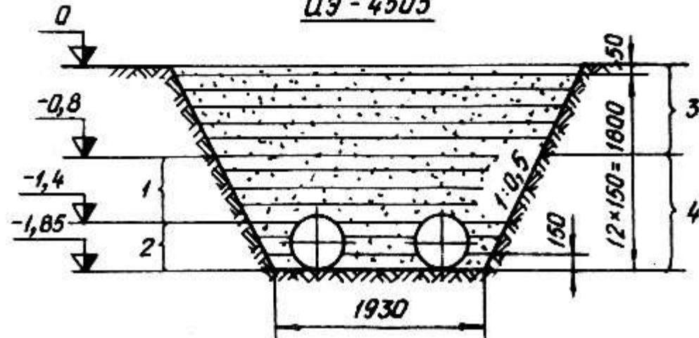
Рис.17. Схемы обратной засыпки и разравнивания грунта при уплотнении электротрамбовками:
