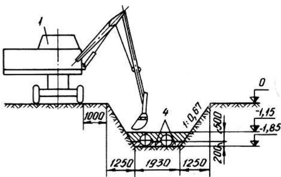
**Рис.5. Схема обратной засыпки и разравнивания грунта экскаватором:**
