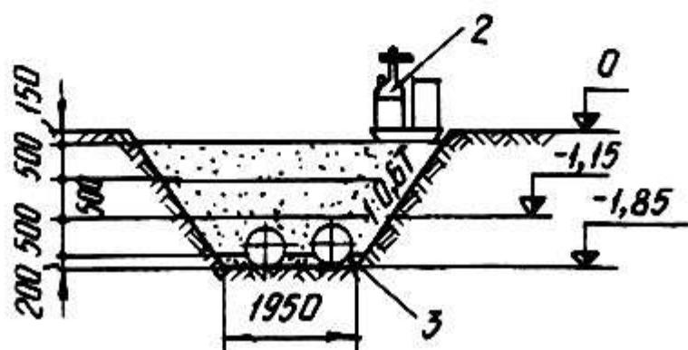
Рис.11. Схема уплотнения несвязного грунта I группы вибрационной плиты:
