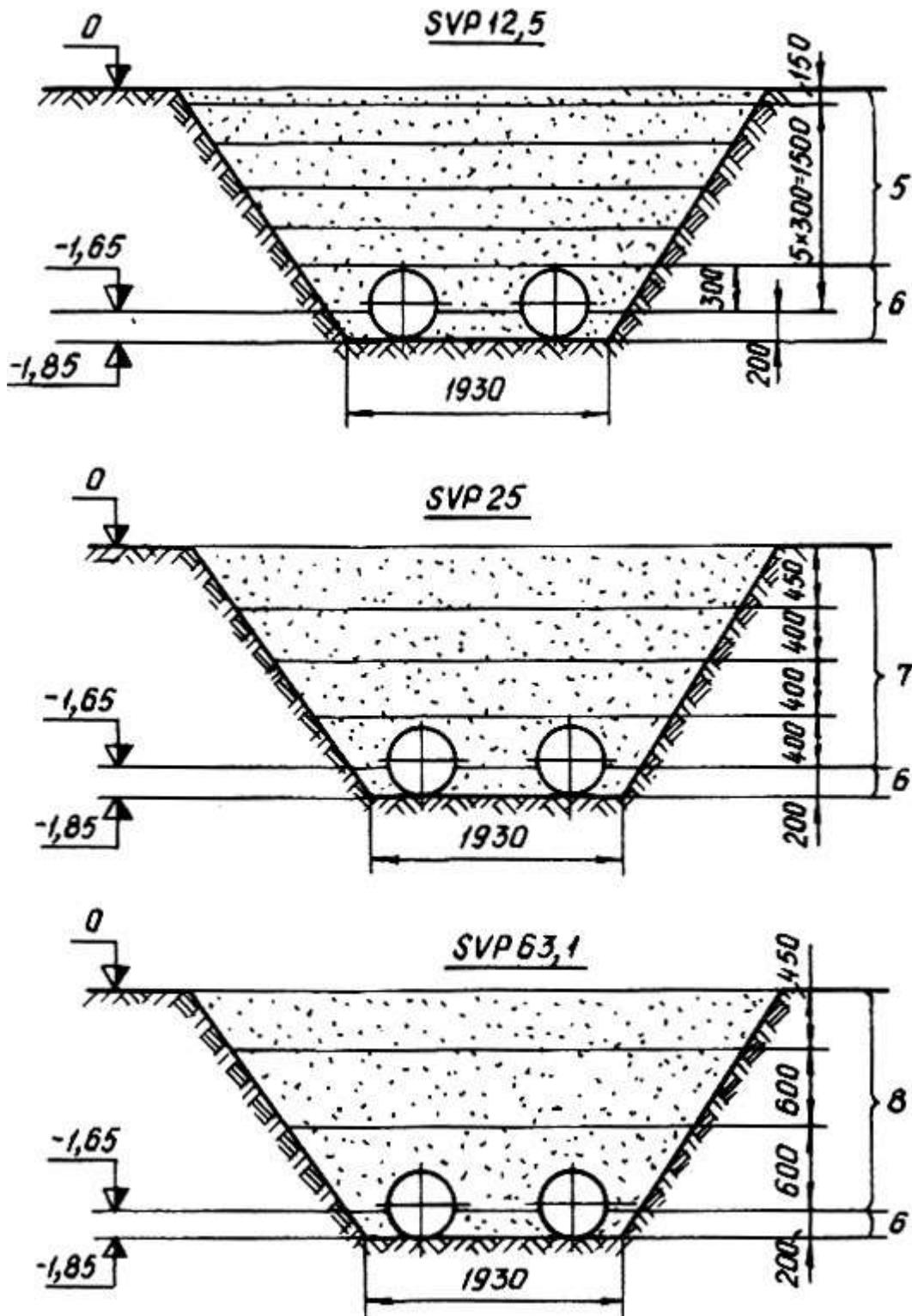
Рис.16. Схемы уплотнения грунта вибрационными плитами:
