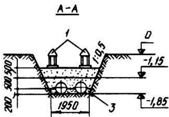
Рис.13. Схема уплотнения связного грунта II группы электротрамбовками:
