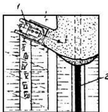
Рис.4. Обратная засыпка траншеи грунтом при помощи бульдозера:
